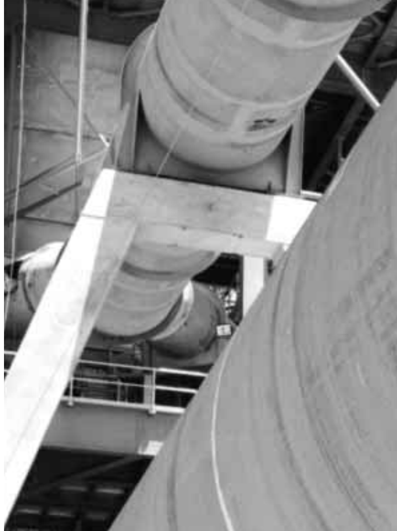
2-Stützen-Ofen POLRO® für einen Durchsatz von 4.900 tato Zementklinker in Australien.
