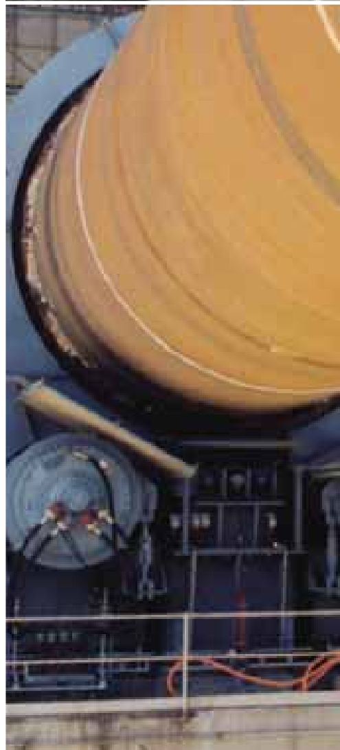
2-Stützen-Ofen POLRO® für einen Durchsatz von 4.900 tato Zementklinker in Australien.
