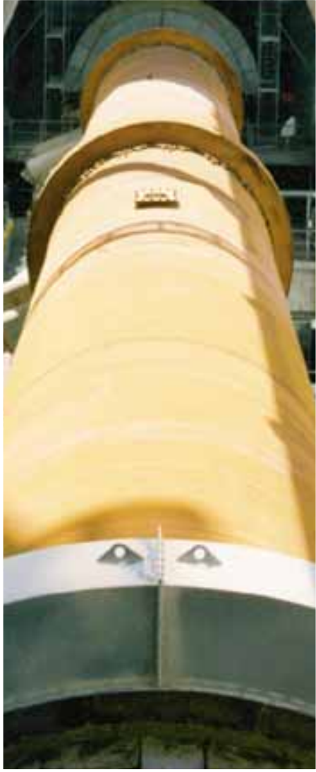
5.000 tato Zement- klinkerofenlinie auf 3 Rollenstationen.
