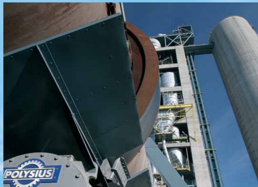
5stufiger DOPOL® '90-Vorwärmer einschließlich PREPOL®-CC-MS-CC-Calciniersystem für 2.600 Tagestonnen Zementklinker in Spanien.
