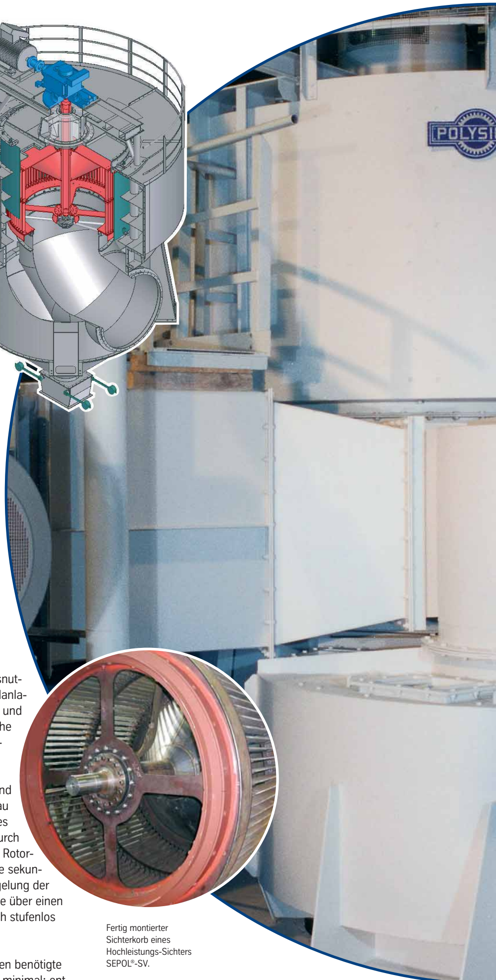
Funktionsdarstellung des Hochleistungs-Sichters SEPOL®-SV.
