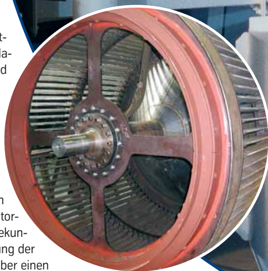
Fertig montierter Sichterkorb eines Hochleistungs-Sichters SEPOL®-SV.
