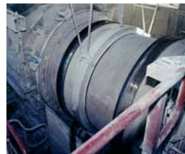
Concept de refroidisseur »twin« dans un atelier à ciment blanc en Espagne.
