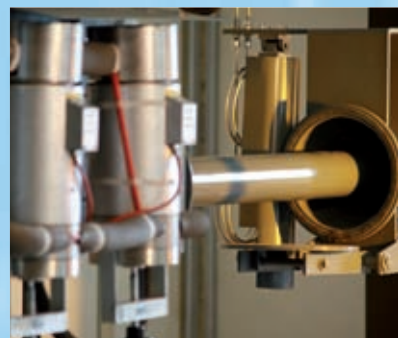
Robustes Gasentnahmesystem für den Ofeneinlauf direkt vor dem Einbau in die Ofenanlage.
