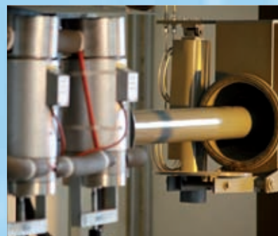
Sistema robusto de toma de gas para la entrada del horno, antes de su montaje en la instalación.
