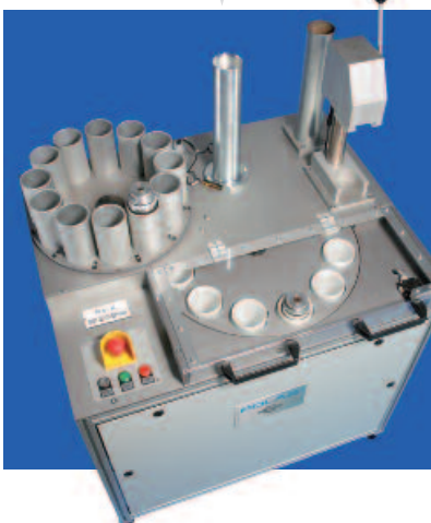
Semiautomatische Rohrpostempfangsstation mit Magazinen für empfangene und leere Rohrpostbüchsen.
