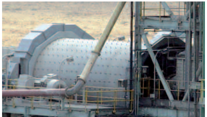
La POLYCOM® y el depurador de Polysius son elementos importantes en el proceso técnico de tratamiento del mineral diamantífero.
