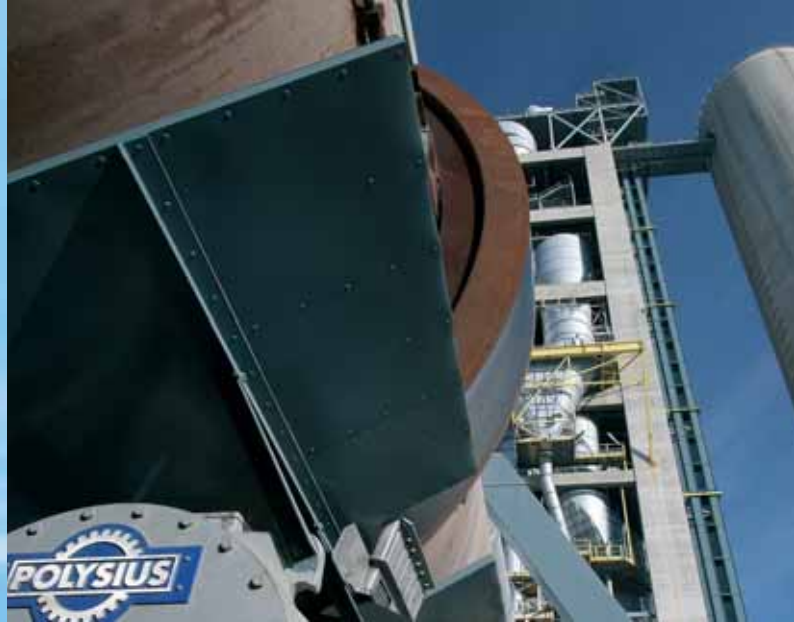
Tháp trao đổi nhiệt 5 tầng DOPOL ® 90 bao gồm hệ thống buồng phân hủy PREPOL ® -CC-MS cho công suất 2.600 tấn/ ngày clanh-ke ở Tây Ban Nha.
