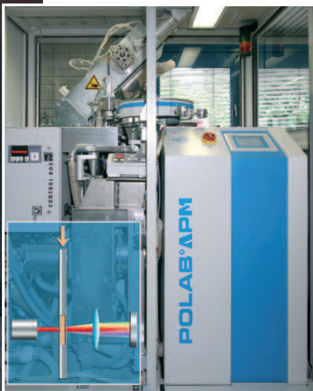
POLAB® АСТ с ключевым компонентом системы подготовки проб: встроены POLAB® АРМ.
