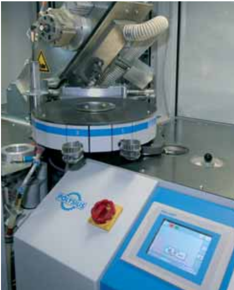
Poste automatique de réception des échantillons ...
