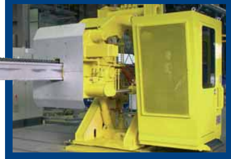
Abschlackmaschine (Bild Mitte) – auch vom Leitstand (Bild oben) aus ferngesteuert zu bedienen.
