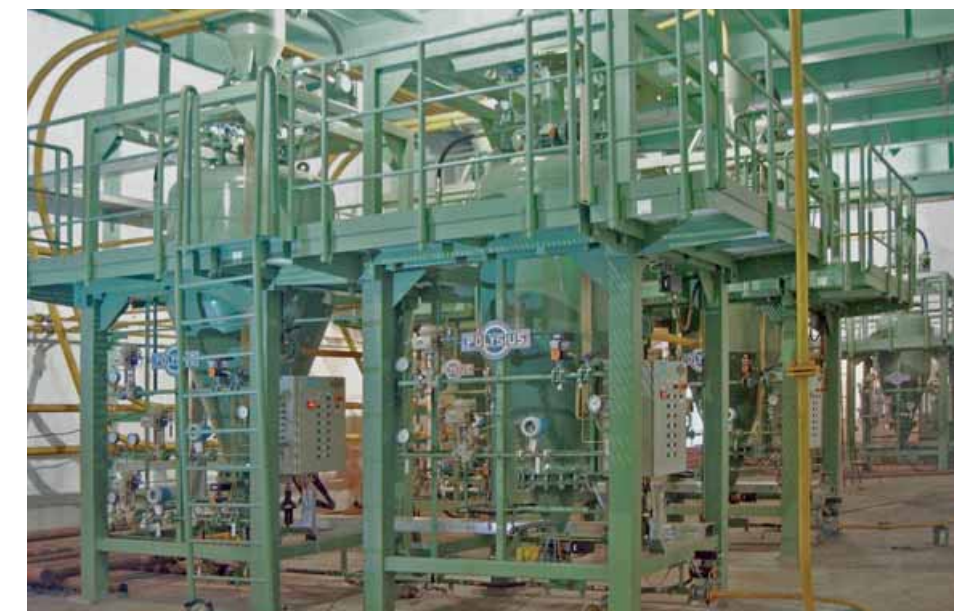
Co-Injektionseinblasförderer in einem chinesischen Stahlwerk.
