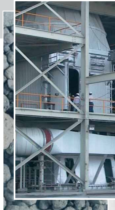
Rollenmühle zur Zementklinkermahlung in Mexiko.
