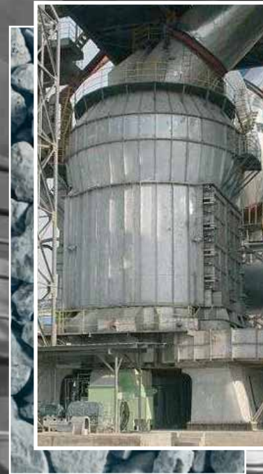
Rollenmühle zur Zementrohmaterialmahlung in China.
