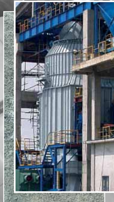
Broyeur à galets de laitier de haut fourneau en Chine.
