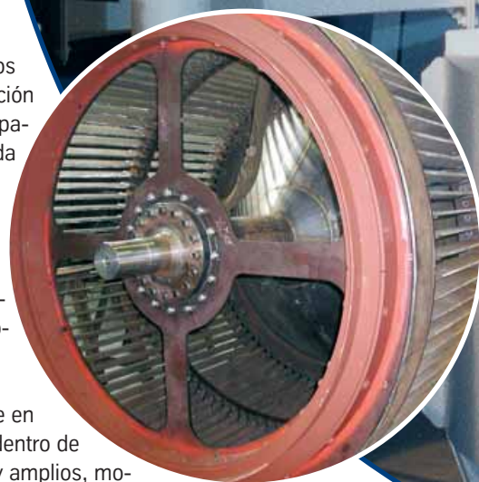
Jaula de clasificación totalmente montada de un separador SEPOL®-SV.
