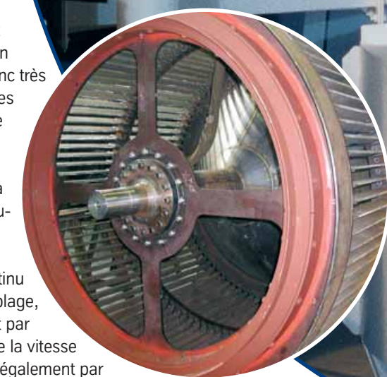
Rotor entièrement assemblé d'un séparateur SEPOL®-SV.
