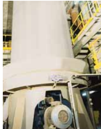
Unidad de accionamiento del enfriador de finos.
