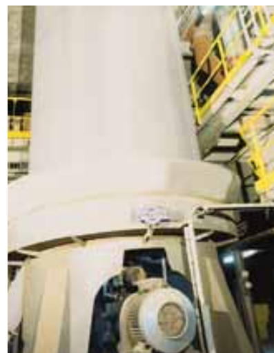
Groupe de commande du refroidisseur à matières pulvérulentes.
