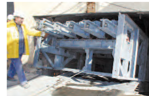
结构紧凑的冷却机在空间受限的情况下也能进行经济合理的增产改造。
