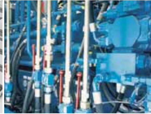
Groupe hydraulique du POLYTRACK®.
