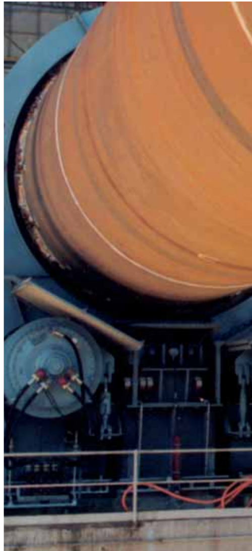
Lò 2 bệ đỡ POLRO® cho năng suất clinker xi măng 4.900 tấn/ ngày ở Australia.
