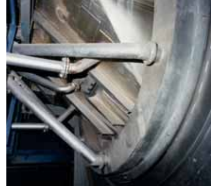
Máng lối vào lò được làm nguội bằng không khí.
