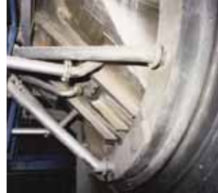
Входной желоб печи с воздушным уплотнением.
