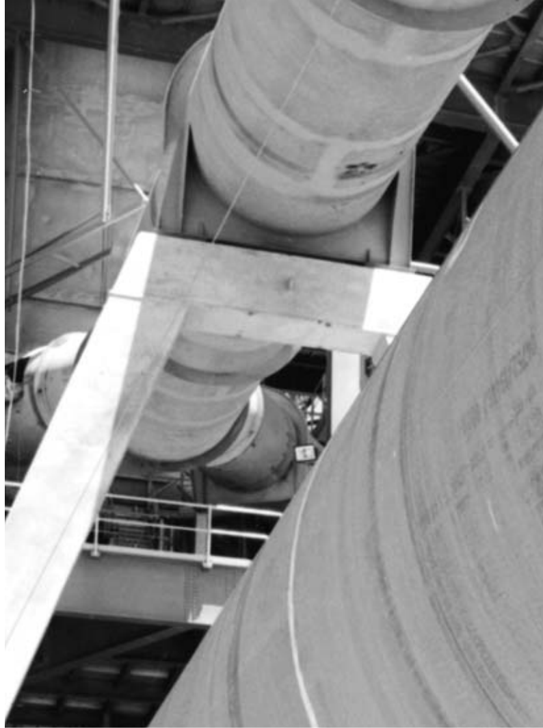
Двухопорная печь POLRO ® производительностью 4900 т/д в Австралии.
