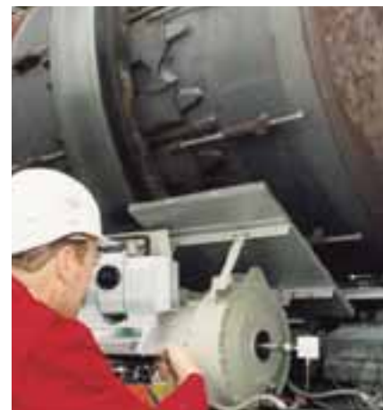
Обмер вращающейся печи системой POLSCAN®.
