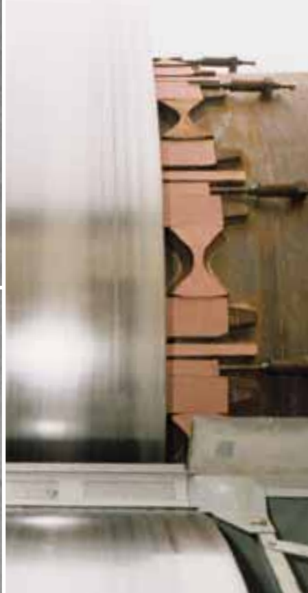
Шплинтовое крепление бандажа печи.
