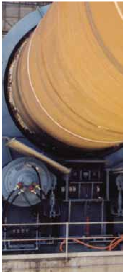
Двухопорная печь POLRO ® производительностью 4900 т/д в Австралии.
