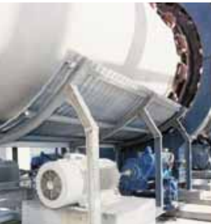
Groupe de commande double attaque de four avec réducteur planétaire.
