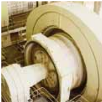
Motor de anillos en un molino semi-autógeno para la molienda de mineral de oro.
