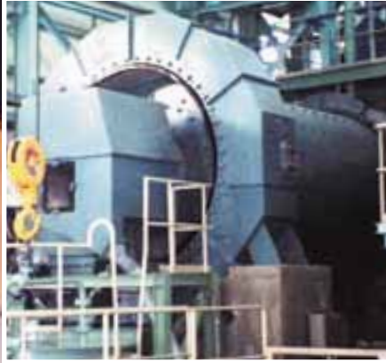
Molino de bolas para la molienda de caliza en un sistema de desulfuración de humos de gas en centrales térmicas.
