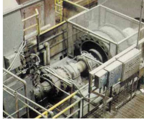
Accionamiento de motor síncrono con embrague por aire.
