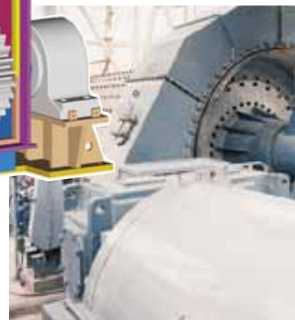
Disposición de piñón estandarizado con engrase de aceite y motor de inducción.
