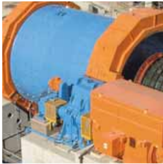
Molino de bolas con COMBIFLEX® para la molienda de mineral pesado de cinc.
